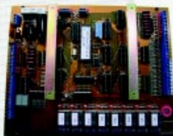
control del ascensor seguridades
