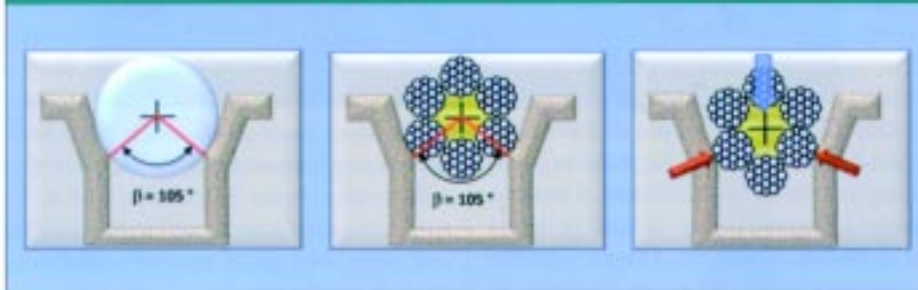
Fig. 17: Entalle de 105^\circ ; forma teórica y deformada del cable
