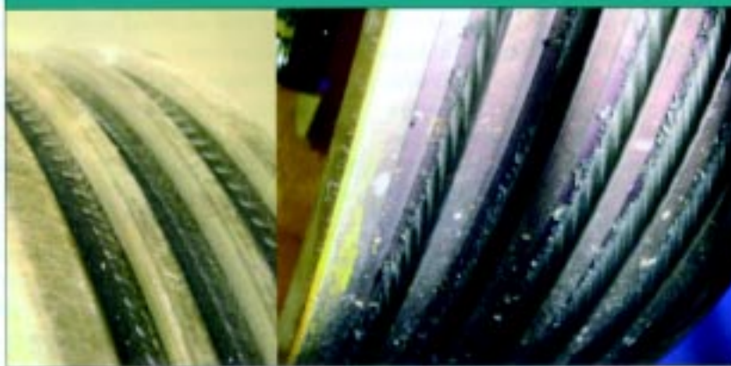
Fig. 18: Gran entalle con una elevada presión específica Resultado: impronta negativa del cable
